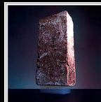
Un mattone di 2,5 kg sostenuto da un blocco di aerogel che pesa solo 2 grammi.
